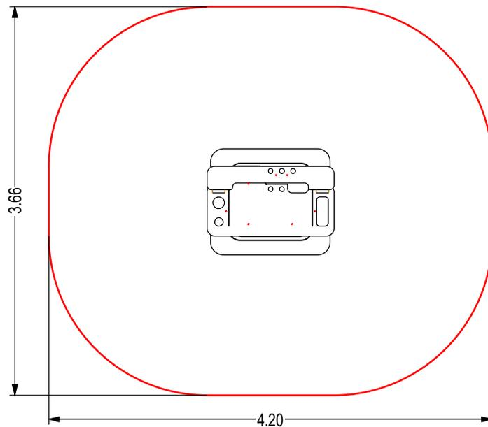
Werden mehrere Elemente aufgestellt, sollte ein Zwischenraum von ca. 1 m vorgesehen werden:
